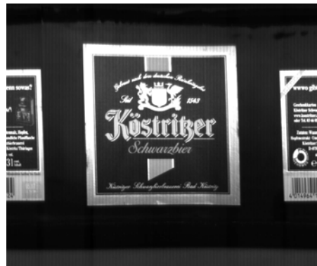
abgerolltes Umfangsbild zur Druckbildkontrolle
